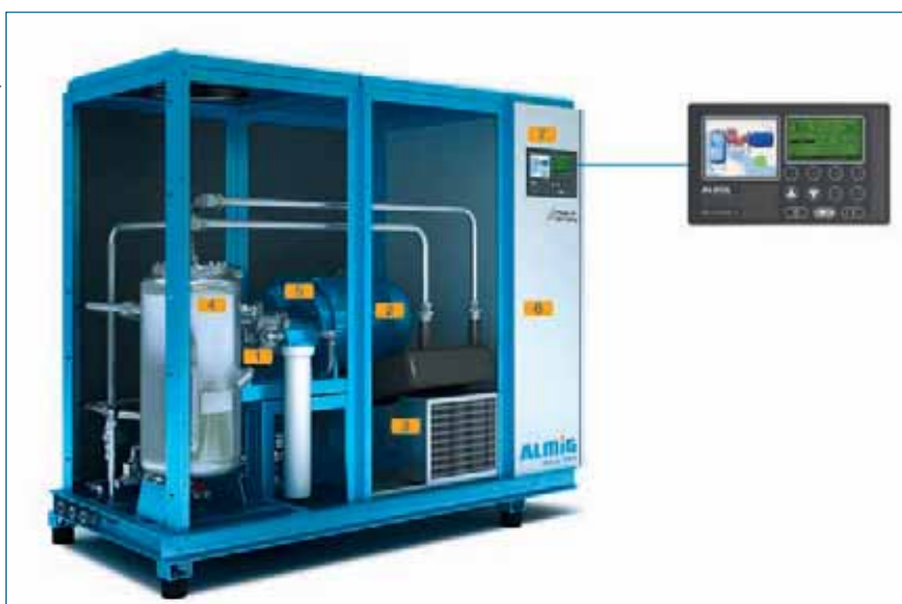
Die wesentlichen Komponenten bei der wassereingespritzten Verdichtung: Verdichter (1), Drehzahl geregelter Antriebsmotor (2), Integrierter Kältetrockner (3), Wasserkreislauf (4), Direktantrieb (5), Frequenzumrichter (6), Mikroprozessor-Steuerung (7)
