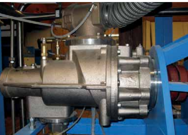
Das Herzstück eines wassereingespritzten Kompressors: die Verdichterstufe aus einer korrosionsfesten Aluminium-Bronze-Legierung
